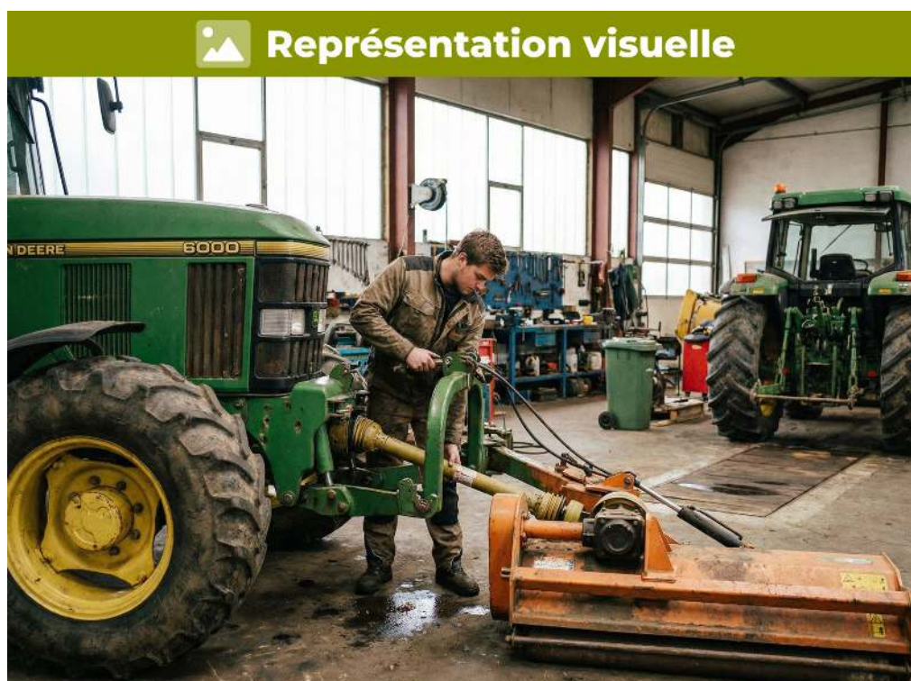
Branchement de l'arbre de prise de force, alignement et sécurité essentiels
